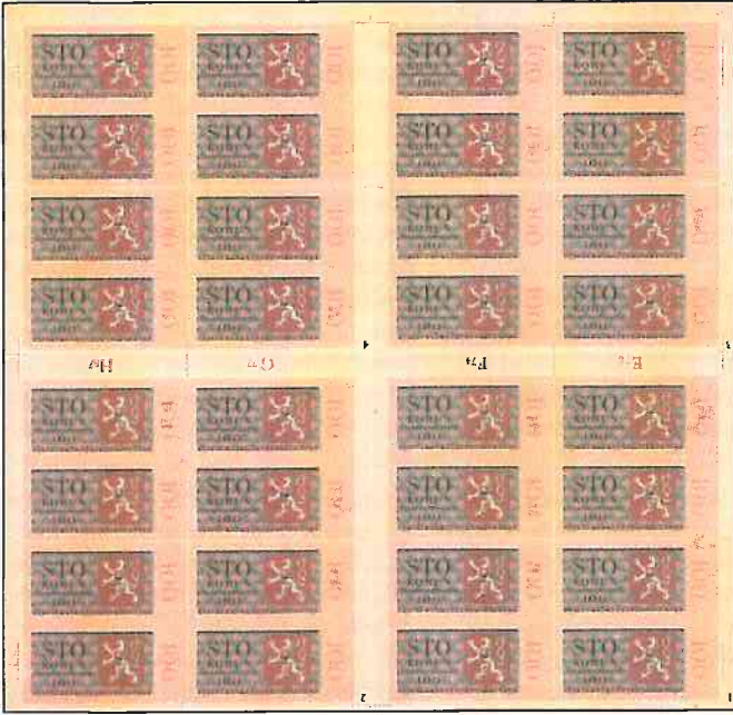
Obr. 5: Lící (nahore) a rubová (dole) strana tiskového archu se všemi plošnými a knihtiskovými operacemi s 32 cedulemi (dole).
